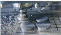
カネテック 小物薄物ワークに最適な 35mm角極小磁極の電磁チャック
