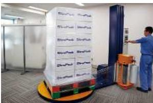
ローラーの速度を利用しストレッチフィルムを最大4倍に引きのばして巻きつけ
